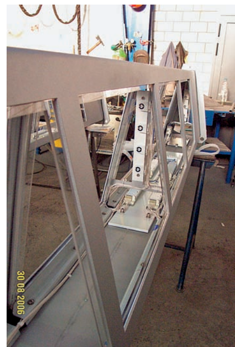
En bas: Déjà intégrée dans l'atelier – l'installation électronique, cachée dans la colonne lumineuse.
